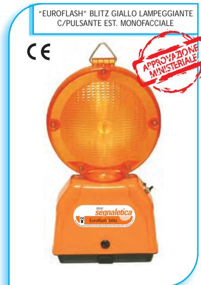
LAMPEGGIATORI DA CANTIERE "EUROFLASH" MODELLO "NORMAL" E "BLITZ" ALIMENTATI DA 2 BATTERIE 4R25; LENTE DIAMETRO 200 mm CHE PERMETTE L'EMISSIONE LUMINOSA CON ROTAZIONE A 360°; ATTACCO SUPERIORE E POSTERIORE PER CONSENTIRE TUTTE LE APPLICAZIONI. I DUE MODELLI CON IL PULSANTE ESTERNO FUNZIONANO 24H SU 24H O SOLO NOTTURNO. GLI ALTRI MODELLI FUNZIONANO SOLO DI NOTTE.
