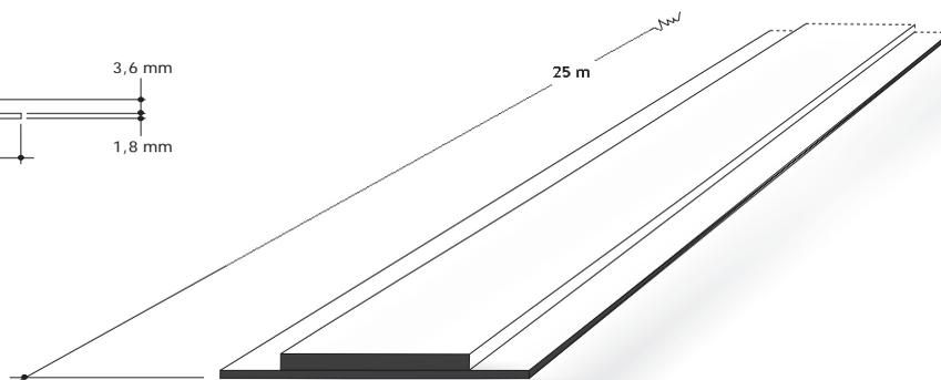
SISTEMA DI RALLENTAMENTO AD EFFETTO ACUSTICO REALIZZATO MEDIANTE IRRUVIDIMENTI DELLA PAVIMENTAZIONE STRADALE, MEDIANTE L'APPLICAZIONE DI STRATI SOTTILI DI MATERIALE IN RILIEVO INTEGRATO CON DISPOSITIVI RIFRANGENTI.
